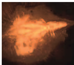
4. Микрофотографии лазерных кратеров на поверхности копоти, образованных при различных расстояниях от линзы L: а – 15 см; б – 16 см; в – 17 см; г – 19 см
